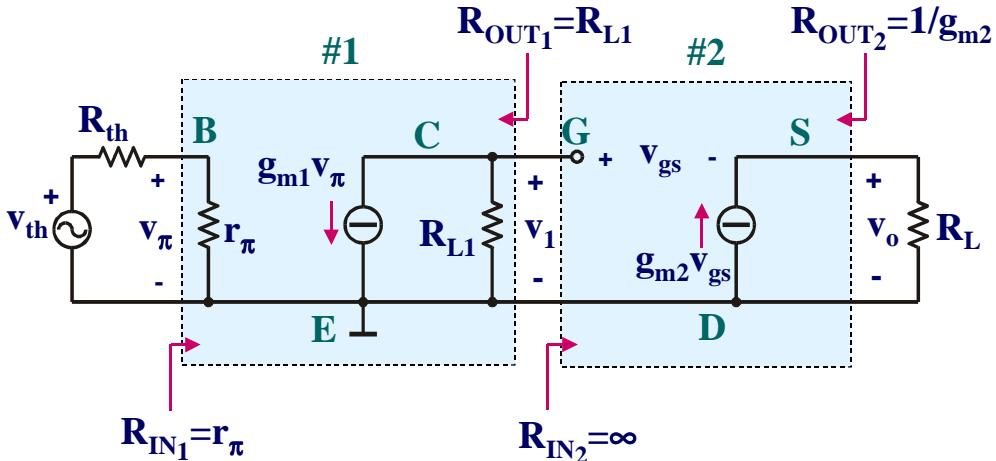
$$R_{L1} = r_{o1} // R_3 // R_{B2} \approx R_3 // R_{B2}$$
